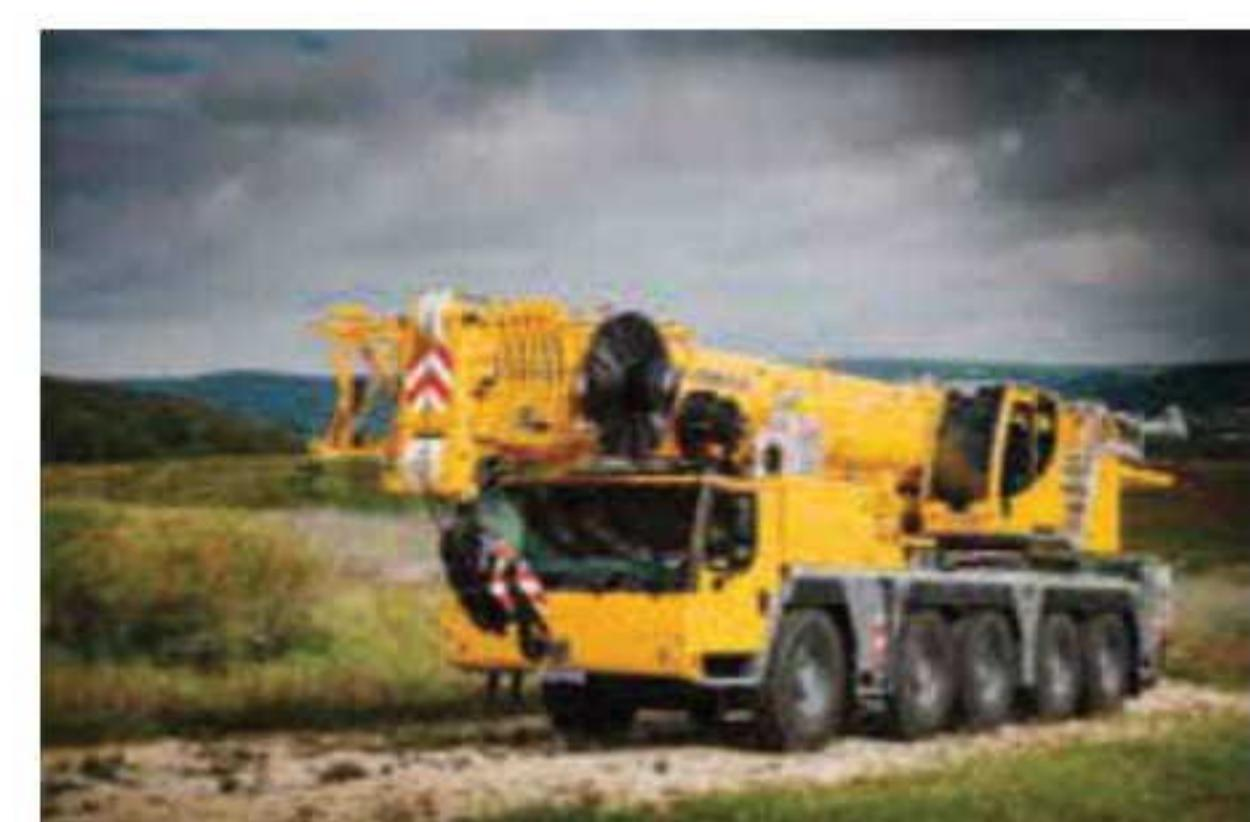
yeni LTM 1150-5.3'te de yer alıyor. Start-Stop özelliği ile rölati sırasında yakıt tasarrufu sunan ECOmode, yapılan işe göre optimal motor devrini otomatik olarak hesaplıyor ve gereksiz yüksek devirden kaçınarak ekstra yakıt tasarrufu sağlıyor."
